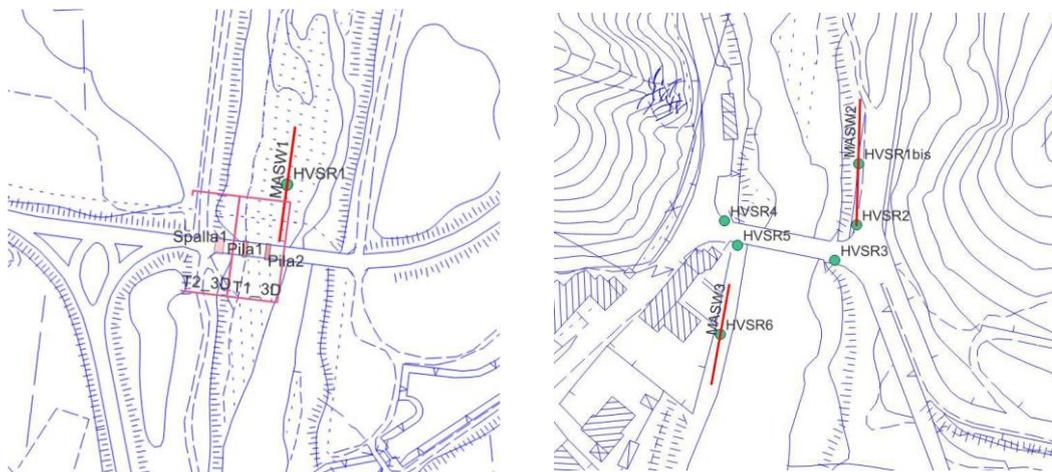
Figura 1- Posizionamento delle indagini geofisiche. Ponte sul T. Leale (a sinistra), ponte dell'Armistizio sul T. Arzino (a destra).
